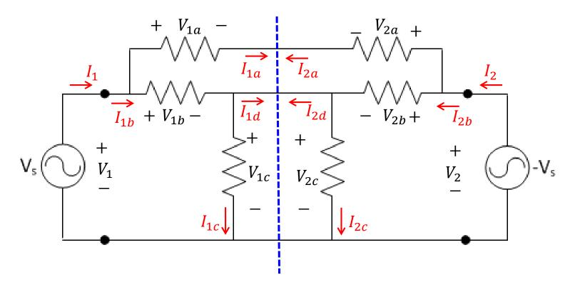
$V_{1} = -V_{2} \qquad V_{1a} = -V_{2a} \qquad V_{1b} = -V_{2b} \qquad V_{1c} = -V_{2c}$  $I_{1} = -I_{2} \qquad I_{1a} = -I_{2a} \qquad I_{1b} = -I_{2b} \qquad I_{1c} = -I_{2c} \qquad I_{1d} = -I_{2d}$
